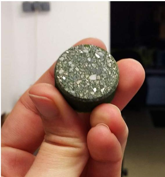
*Figura 6. Preparación de la superficie de la probeta para pegarla al cristal porta objetos. Se realiza un ligero desbaste para igualar la superficie y se redondean los bordes con la misma pulidora para facilitar el pegado.*
