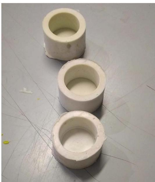
*Figura 3. Moldes de silicona cilíndricos. Este formato permite estudiar una misma muestra tanto en el sistema AMCO con en un sistema de microscopía electrónica o por métodos tradicionales.*
