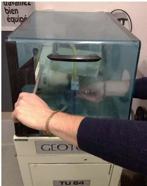
*Figura 9. Disco de precisión para rebajar la probeta a 1mm*
