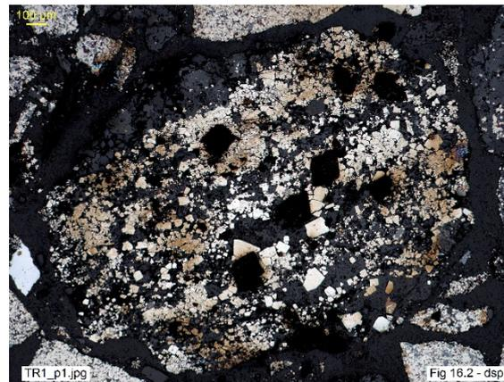
*Figura 16. Irregularidades en la superficie de la preparación debido a diferentes durezas en el material: pérdida de granos minerales, poros y relieve.*
