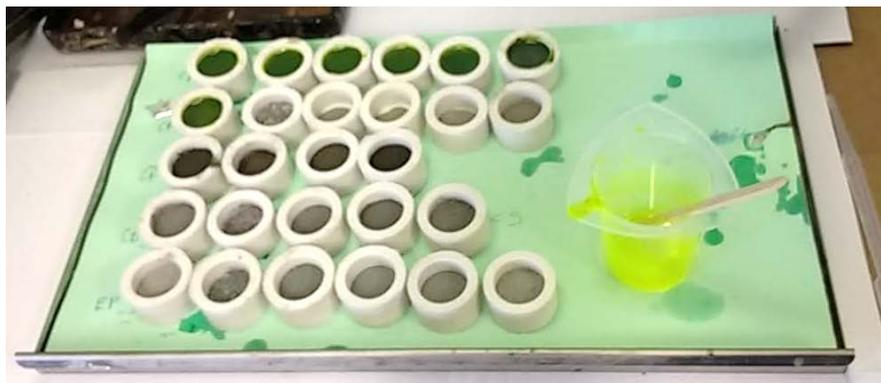
*Figura 5. Embutido de las muestras de molienda en resina fluorescente*
